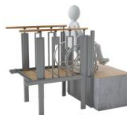
Rys. 8: Zjeżdż z platformy
